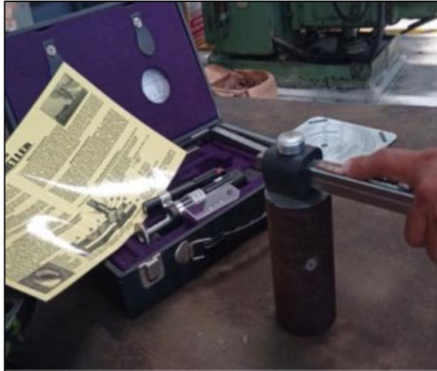
Figura 5.5. Se coloca el yunque en la probeta.
