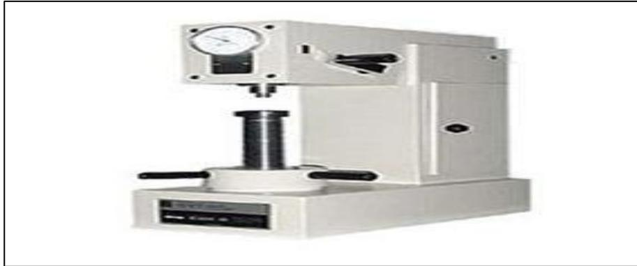
Figura 3.4: Durómetro, máquina para medir la dureza de los materiales.
