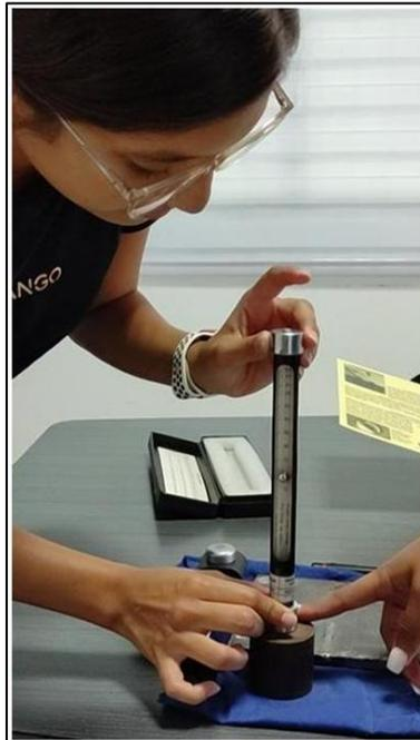
Figura 5.12 Funcionamiento del durómetro.
