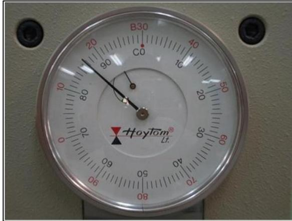
Figura 3.7: Dial del durómetro.
