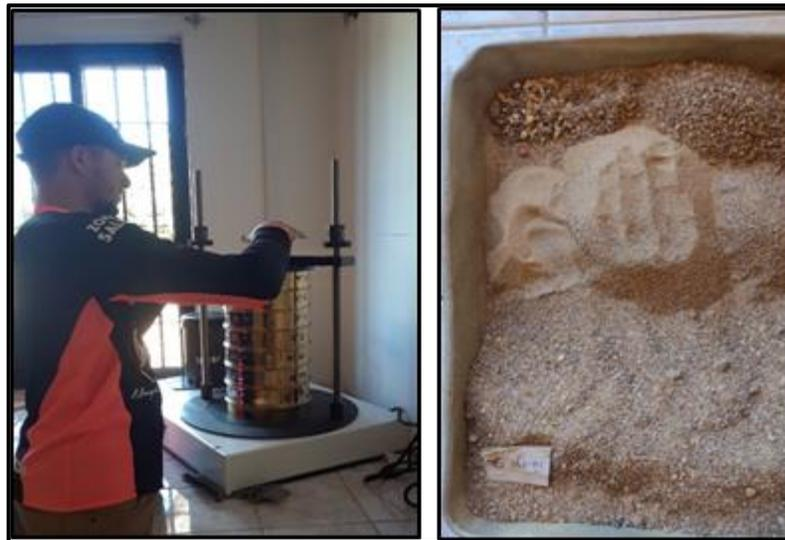
Figura 4.9 Programando tamizadora en el lado izquierdo y del lado derecho resultado de la muestra tamizada.
