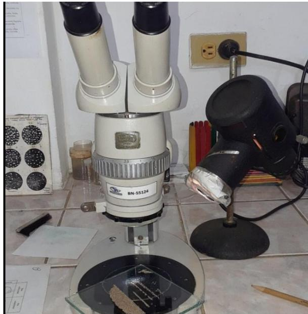
Figura 4.10 Microscopio óptico.
