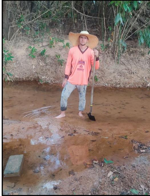
Figura 4.5 Toma de sedimentos del río para evaluar el transporte de las partículas.
