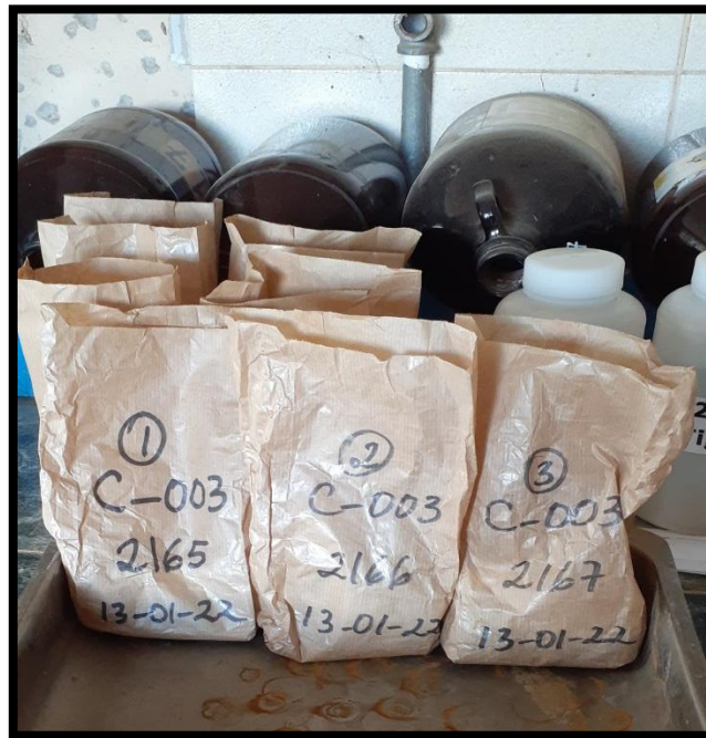
Figura 5.1 Muestras pulverizadas para realizar análisis químico.
