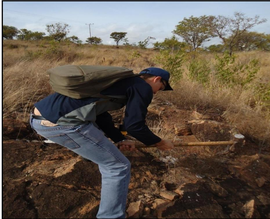
Figura 4.3 Proceso de la toma de muestras por el método de percusión con mandarría
