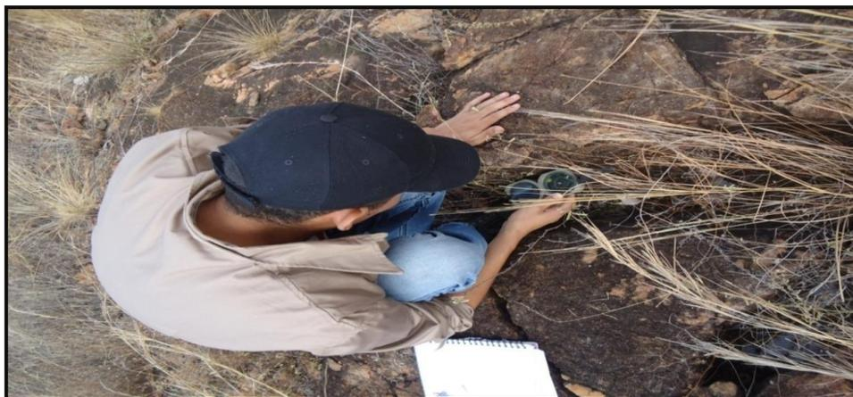
Figura 4.5 Medición de las diaclasas encontradas en el afloramiento.
