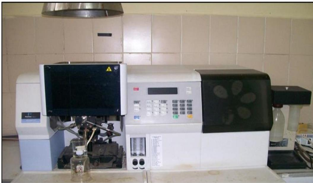
Figura 4.4 Espectrofotómetro de absorción atómica, Perkin Elemer
