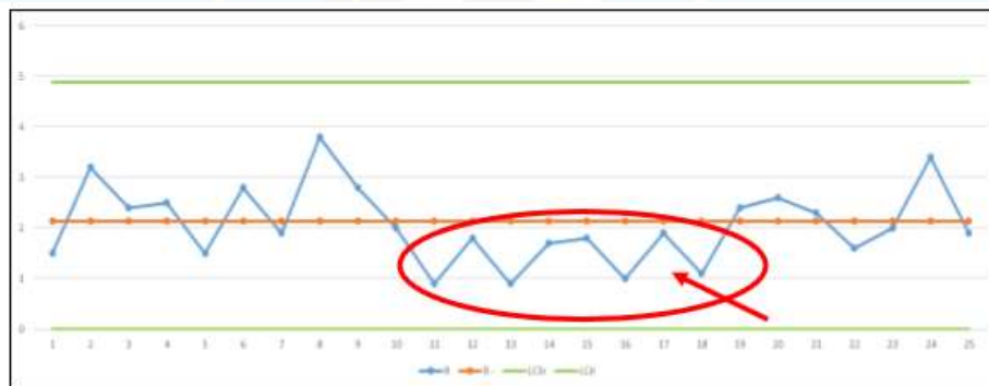
Figura 44. Gráfica de control para el rango de temperatura en el mes de agosto en la línea de producción de maíz.
