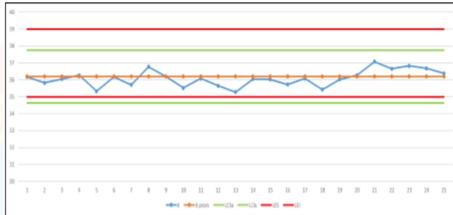
Figura 43. Gráfica de control para promedios de temperatura en el mes de agosto en la línea de producción de maíz.
