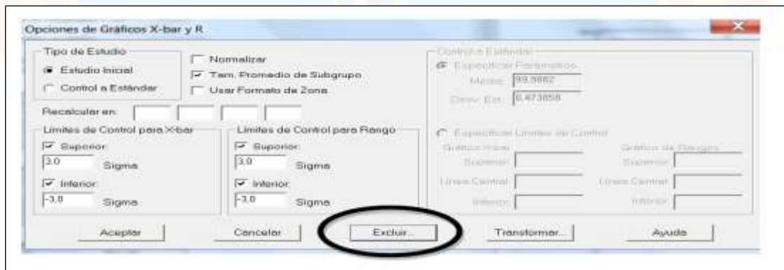
Figura 34. Ajuste de puntos fuera de control en Análisis en Gráfico de datos en el Statgraphics.
