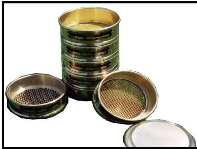
Figura 3.5. Juego de tamices usados para la clasificación de un sedimento (Bosch, M. 2017)
