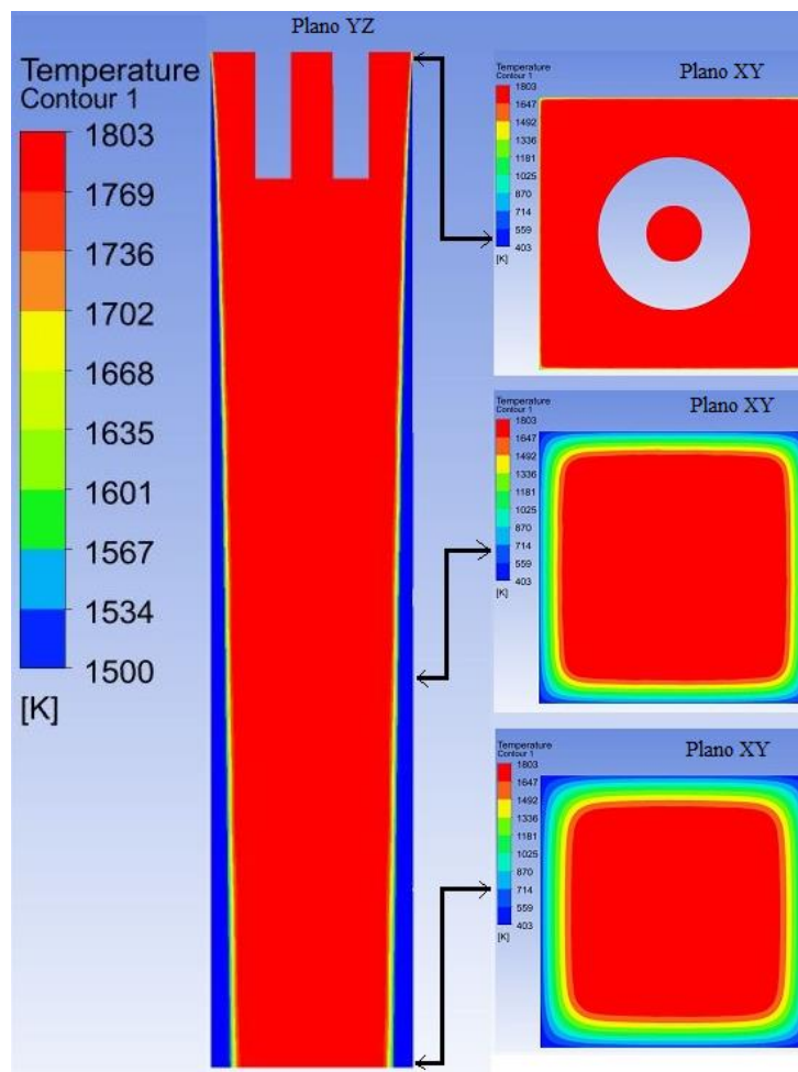
Figura 0.13 Contornos de temperatura en la costra sólida en el Plano YZ y cortes transversales en el Plano XY a las distancias desde el menisco de 0,001 m, 0,500 m y 0,800 m .
