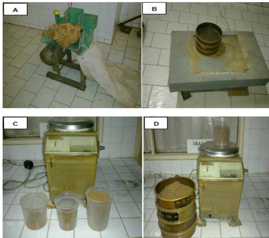
Figura 2A. Repicadora de martillo, potencia 3 HP, rotación 3500 rpm marca DP JUNIOR. B. Agitador de tamices. C. Separación de las partículas por tamaño de fibras y preparación del sustrato. D. Pesada del sustrato.
