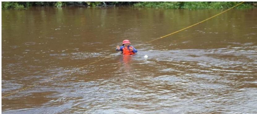
Figura. 5.16 Medición de velocidades con flotadores en el centro de la sección (a) punto inicial del río Caris.
