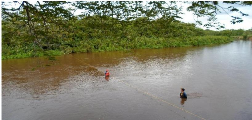
Figura. 5.15 Medición de velocidades con el correntómetro en el centro de la sección (b) del río Caris.
