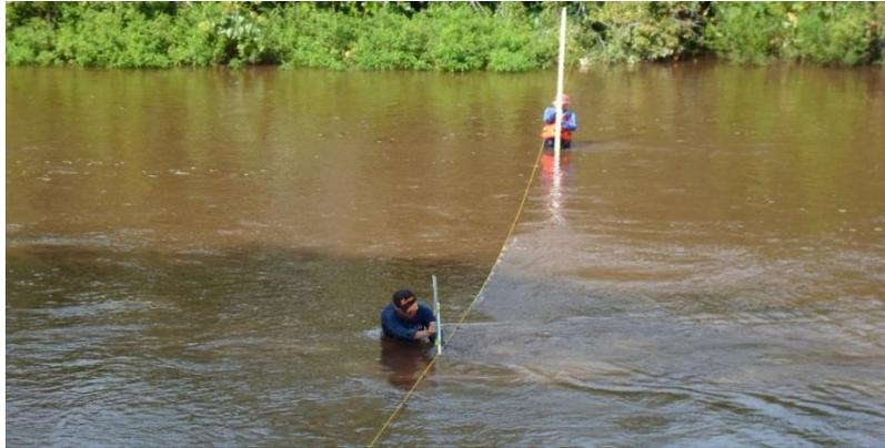
Figura. 5.14 Medición de velocidades con el tubo Pitot en el centro de la sección (b) del río Caris.
