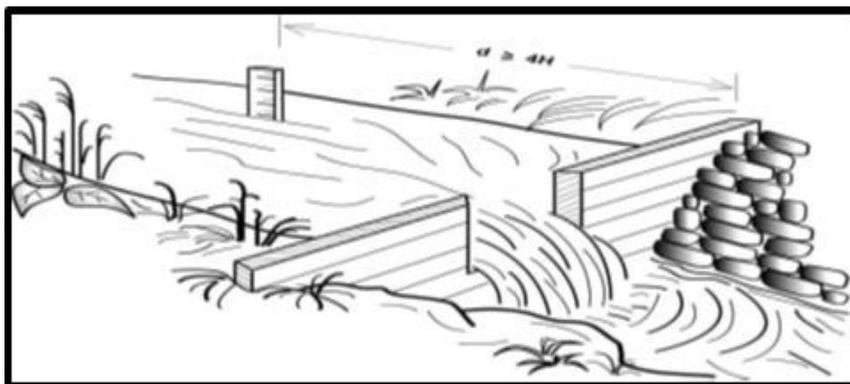
Figura. 3.4 Vertedero en funcionamiento. (Sandoval, 2010).
