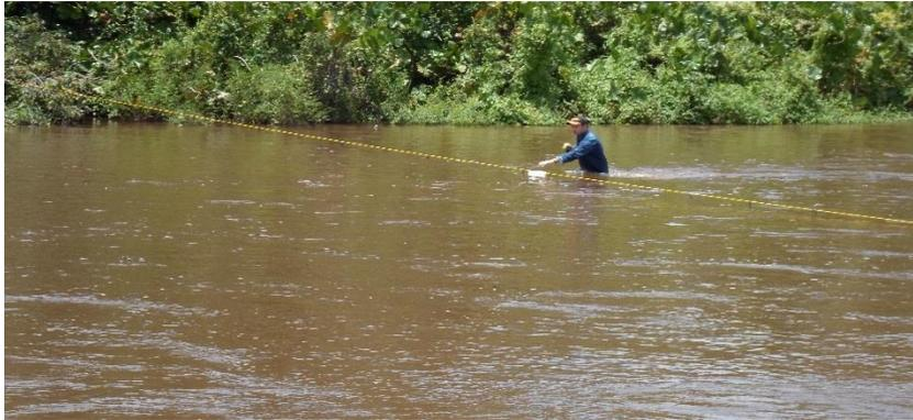
Figura. 5.17 Medición de velocidades con flotadores esperando en la sección (b) punto final del río Caris.
