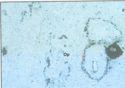
**Muestra EST2 (N/) 10X/10X:** se observa la huella del mineral primario (plagioclasa) que ha sido sustituido por agregados de minerales opacos y minerales de alteración
