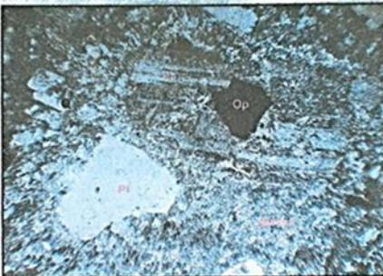
**Muestra EST-1 (NX) 10X/2X:** textura porfídica-seriada con matriz felsítica-microporfídica, formado por fenocristales de plagioclasa (Pl) con inclusión de opaco (Op), matriz formada por cuarzo, plagioclasa, clorita, epidota y carbonato.
