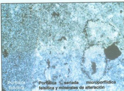
**Muestra EST2 (NX) 10X/10X:** se observa dos tipos de texturas a la derecha es porfídica seriada en una matriz microporfídica felsítica y minerales de alteración (sericita y clorita). En la izquierda matriz porfídica en una matriz felsítica.
