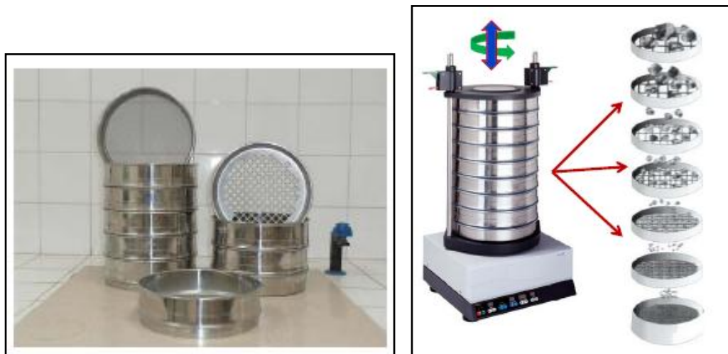
Figura 4.2 Esquema representativo de como se realiza el Análisis Granulométrico.
