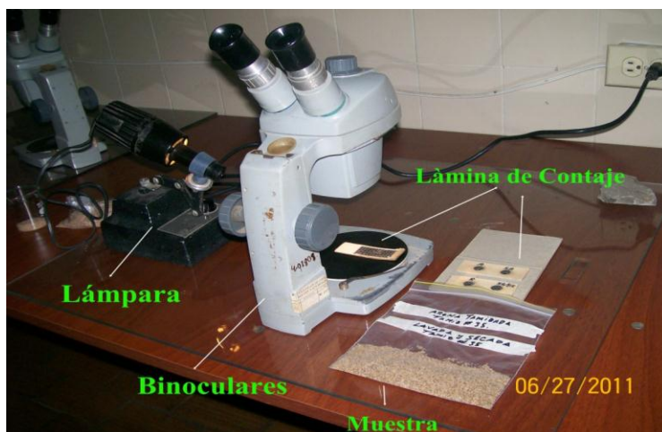
Figura 4.4 Equipos utilizados en el análisis Morfoscópico
