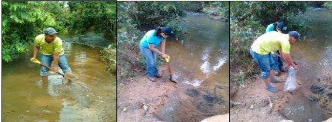
Figura 4.2. Toma de muestra de sedimentos
