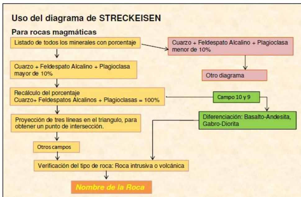
Figura 3.3 Uso del diagrama de Streckeisen en rocas magmáticas (Griem y Griem, 2008).
