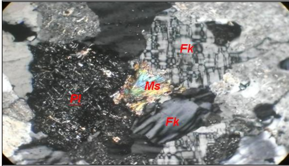
Figura 5.12 Muestra MS-2 (NX) 10X/10X: Se observa plagioclasa (Pl), totalmente sericitizada; feldespato (Fk) tipo microclino y mica muscovita (Ms).
