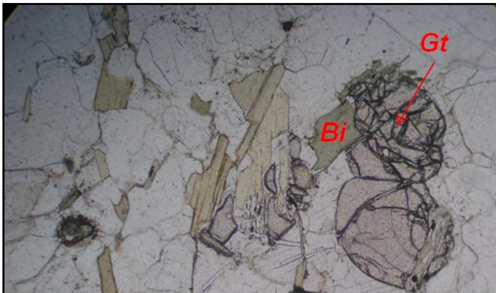
Figura 5.9. Muestra MS-1(N//) 10X/4X: Se observa cristales de granate (Gt) muy fracturado y relleno por mica Biotita (Bi) siendo sustituida por esta.
