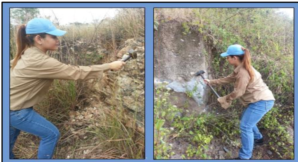
Figura 4.6 Extracción de muestras utilizando el método de percusión.
