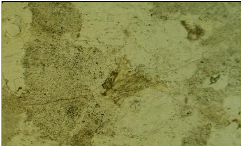
Figura 5.13 Muestra MS-2 (N//) 10X/10X: Se observa paquetes de cristal de mica muscovita (Ms) deformada y se observa la fuerte alteración sericitica en el cristal de plagioclasa.
