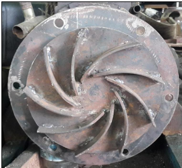
Figura B.10 Pieza unión con impeler
