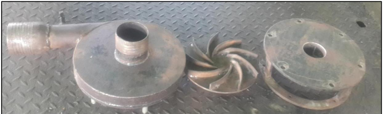
Figura B.12 Partes de la turbina
