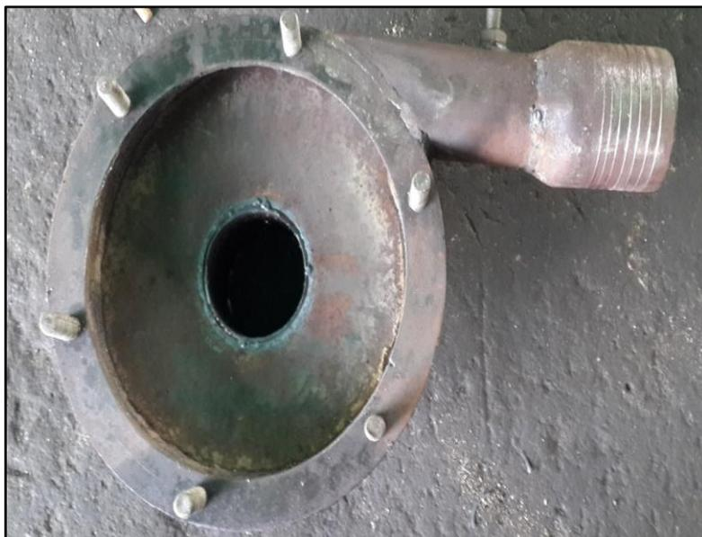
Figura B.6 Pieza orbita unido con pieza carcaza y niples de entrada y salida
