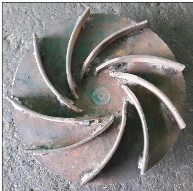
Figura B.8 Pieza impeler con rosca de eje y alabes
