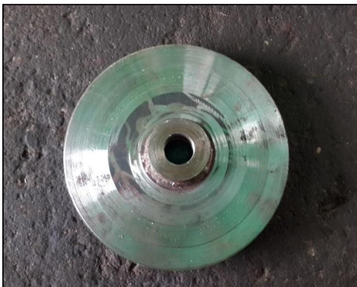
Figura B.7 Pieza impeler con rosca de eje
