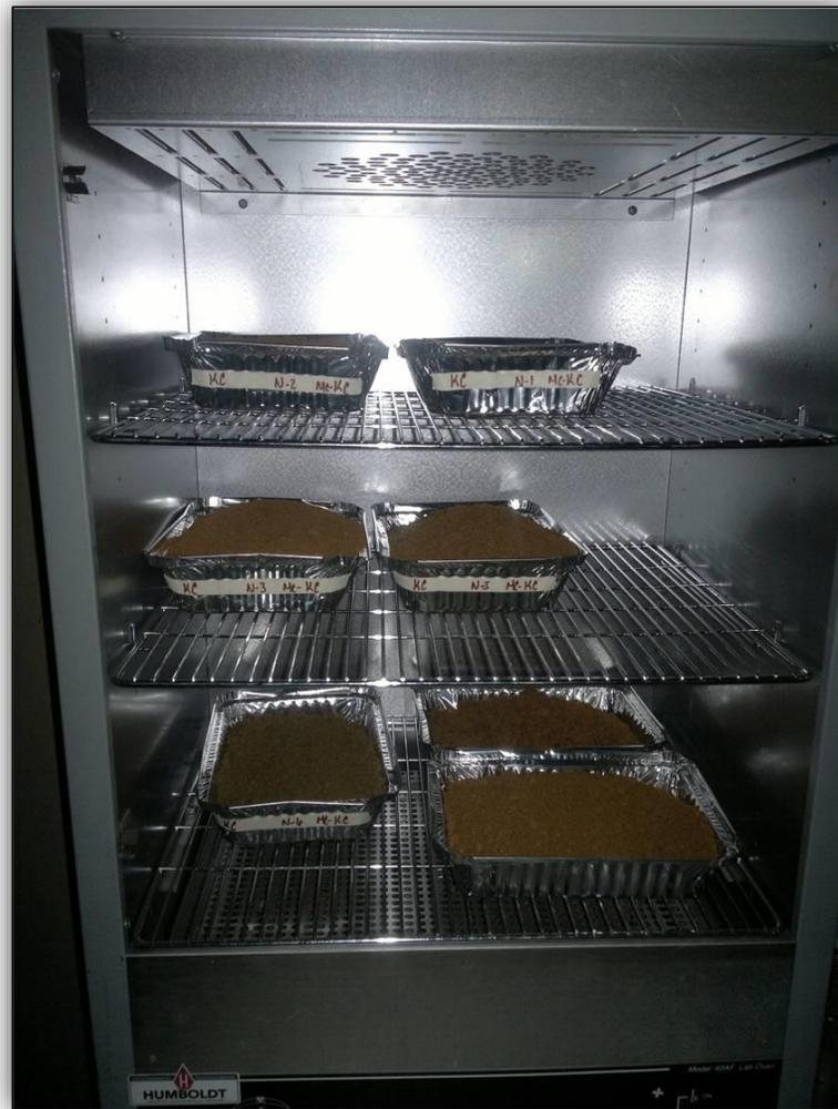
Figura 4.6 Secado de muestras en horno.
