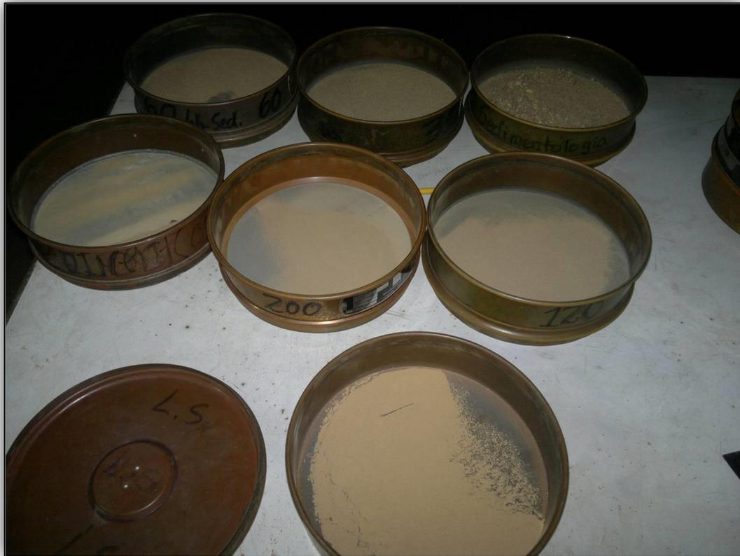
Figura 4.7 Clasificación granulométrica de muestra.
