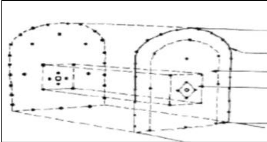
Figura 3.6 Diseño del mallado de fondo y de frente de una galería
