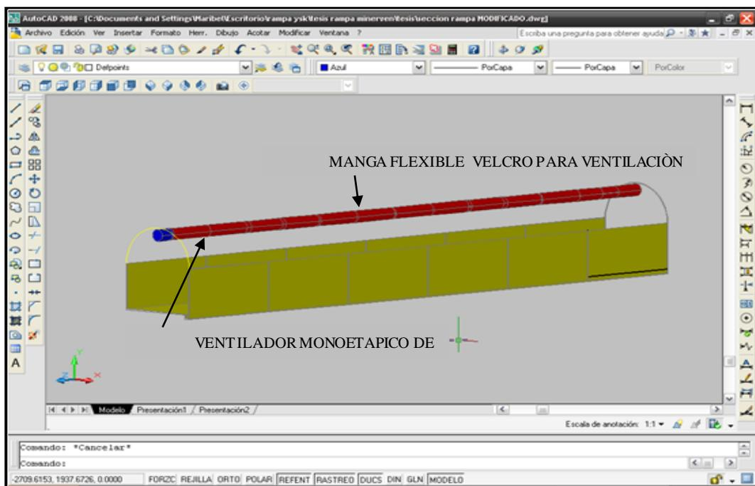
Figura 5.10 Tramo de sección del sistema de ventilador-mangas.
