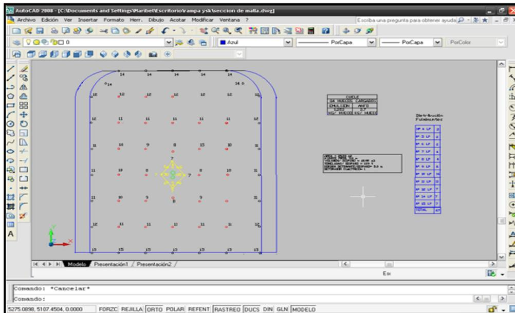
Figura 5.9 Diseño del patrón de perforación y voladura
