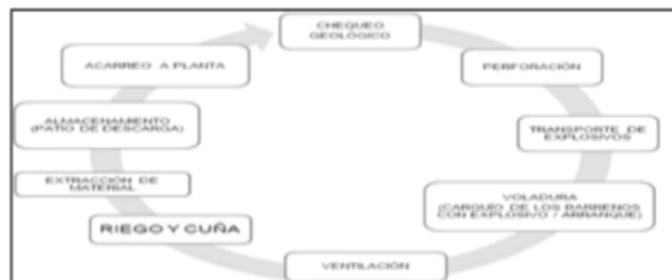
Figura 2.9. Flujograma de operaciones de la Mina Sosa Méndez, Minerven C.A.
