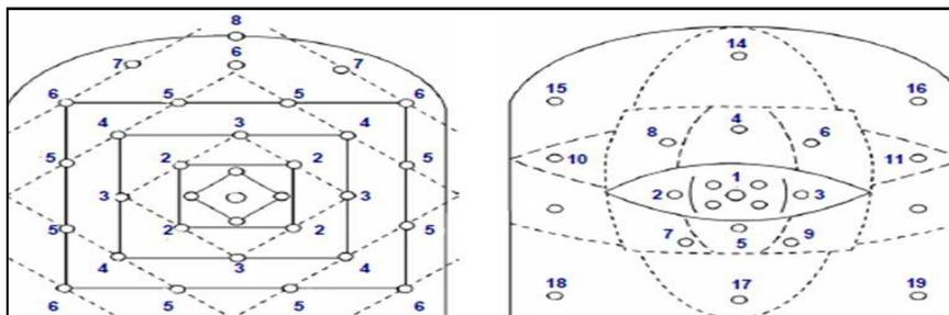
Figura 3.8 Ejemplo del diseño del esquema de disparo.
