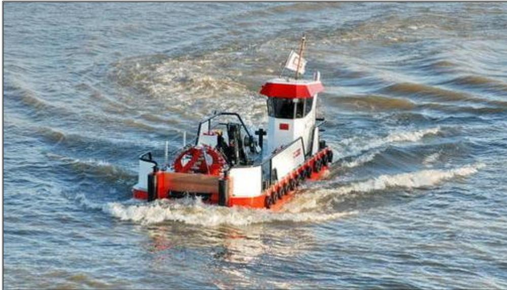
Figura 5.4 Barco DCM 1050 para el dragado.
