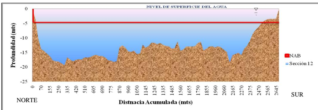
Figura C.59 Sección transversal N° 12 ubicada en el sector Sacupana. (Plano N° OODB5416 año 2001).
