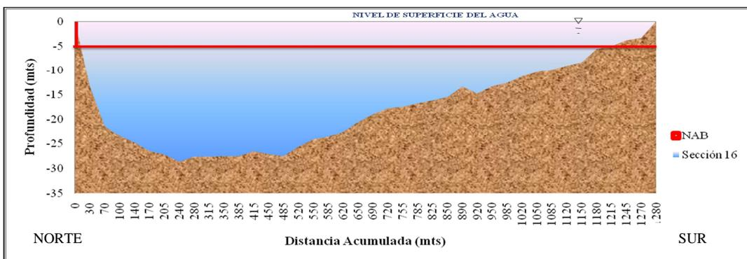
Figura C.33 Sección transversal N° 16 ubicada en el sector Araguaito. (Plano N° OODB5422 año 2001).
