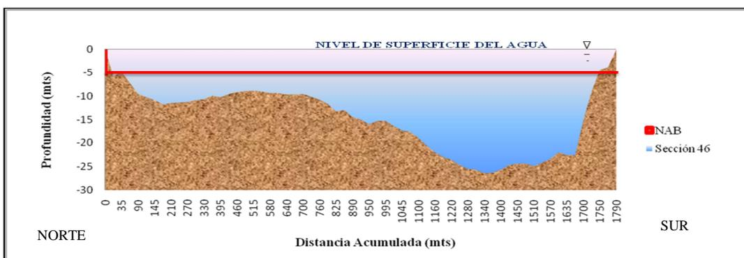
Figura C.3 Sección transversal N° 46 ubicada en el sector Araguaito. (Plano N°OODB5422 año 2001).
