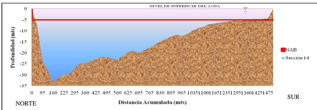
Figura C.35 Sección transversal N° 14 ubicada en el sector Araguaito. (Plano N° OODB5422 año 2001).
