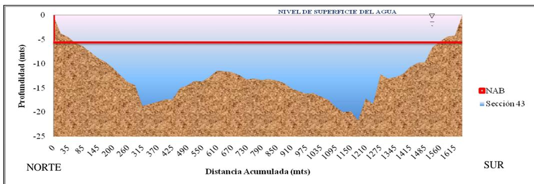
Figura C.6 Sección transversal N° 43 ubicada en el sector Araguaito. (Plano N°OODB5422 año 2001).
