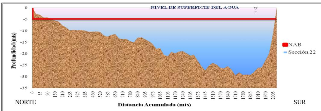
Figura C.49 Sección transversal N° 22 ubicada en el sector Sacupana. (Plano N° OODB5416 año 2001).
