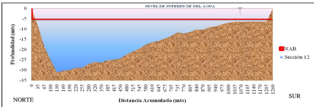
Figura C.37 Sección transversal N° 12 ubicada en el sector Araguaito. (Plano N° OODB5422 año 2001).
