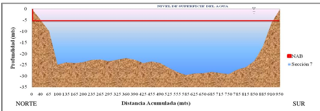
Figura C.42 Sección transversal N° 7 ubicada en el sector Araguaito. (Plano N° OODB5422 año 2001).
