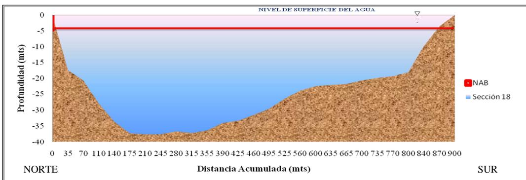
Figura C.31 Sección transversal N° 18 ubicada en el sector Araguaito. (Plano N° OODB5422 año 2001).
