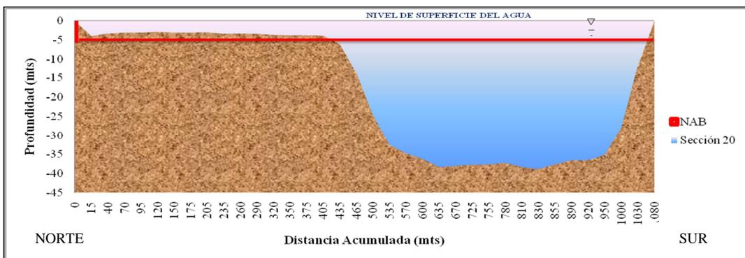
Figura C.29 Sección transversal N° 20 ubicada en el sector Araguaito. (Plano N° OODB5422 año 2001).
