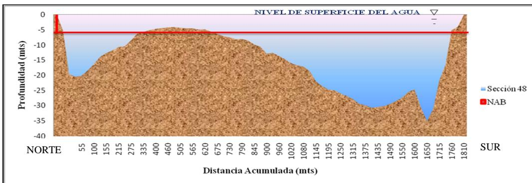
Figura C.1 Sección transversal N° 48 ubicada en el sector Araguaito (Plano N°OODB5422 año 2001).
