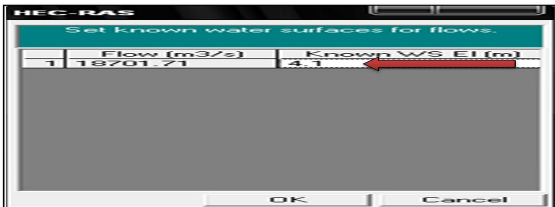
Figura 4.8 Ingresando el nivel del agua para el caudal en la sección de aforo Tres caños Norte, del sector Araguaito.
