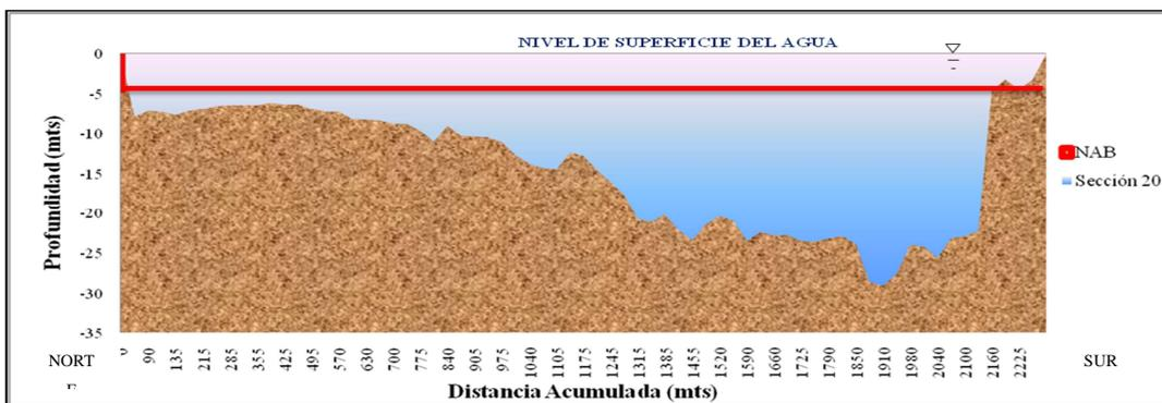
Figura C.51 Sección transversal N° 20 ubicada en el sector Sacupana. (Plano N° OODB5416 año 2001).
