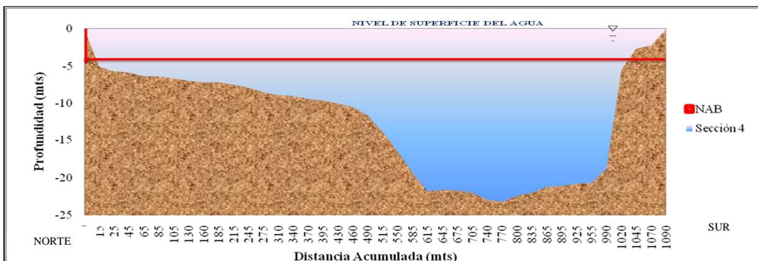
Figura C.67 Sección transversal N° 4 ubicada en el sector Sacupana. (Plano N° OODB5416 año 2001).
