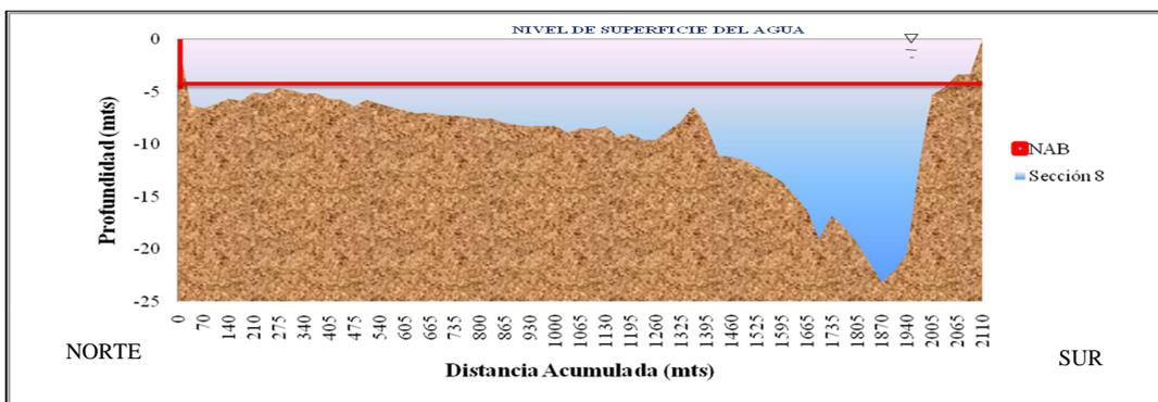
Figura C.63 Sección transversal N° 8 ubicada en el sector Sacupana. (Plano N° OODB5416 año 2001).
