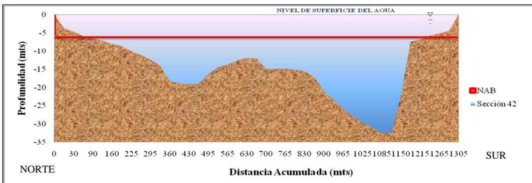
Figura C.7 Sección transversal N° 42 ubicada en el sector Araguaito. (Plano N°OODB5422 año 2001).
