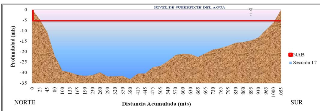
Figura C.32 Sección transversal N° 17 ubicada en el sector Araguaito. (Plano N° OODB5422 año 2001).
