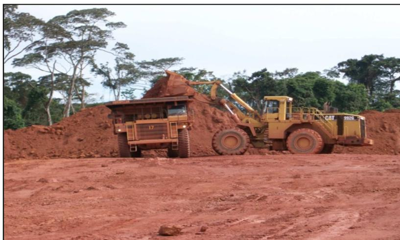
Figura. 3.10 Proceso de carga del mineral.
