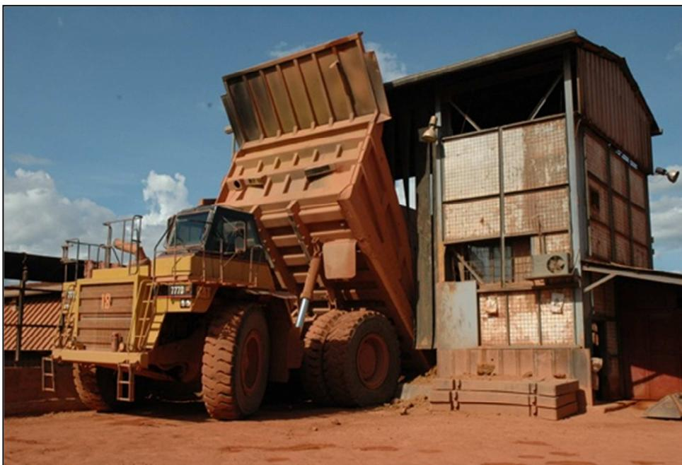
Figura 3.12 Descarga en el molino de trituración.
