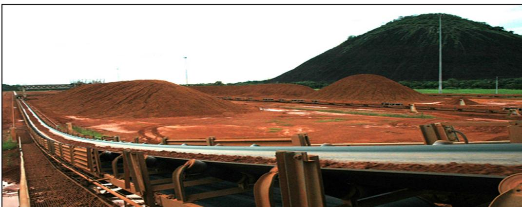
Figura 3.16 Llegada del material bauxítico y almacenamiento en forma de pila tipo Chevron.
