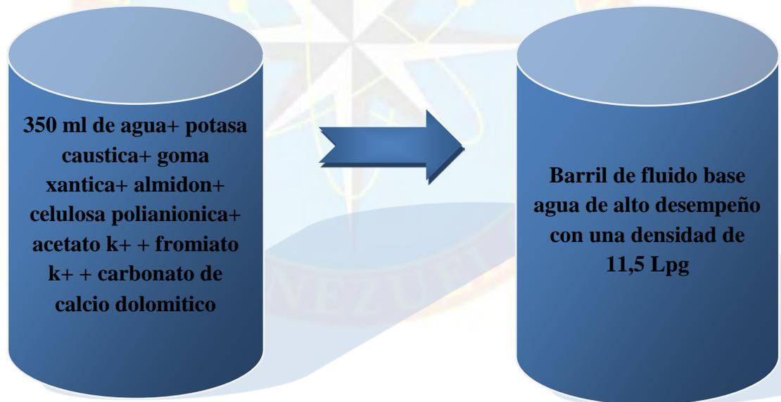
**Preparación de un barril de fluido base agua de alto desempeño densificado con carbonato de calcio, para una densidad de 11,5 lpg y usando como inhibidor de arcillas un Glicol.**
