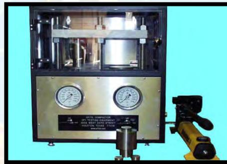
Figura B.1.8.- Compactador de Arcillas
