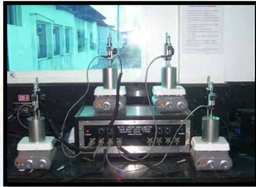
Figura B.1.9.- Equipo de Medición del Hinchamiento Lineal
