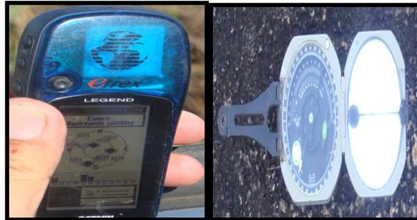
Figura 4.5 GPS y Brújula empleados en la toma de coordenadas.
