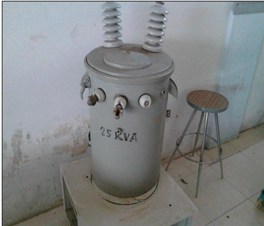
Figura B.13 Transformador de prueba 25 KVA
