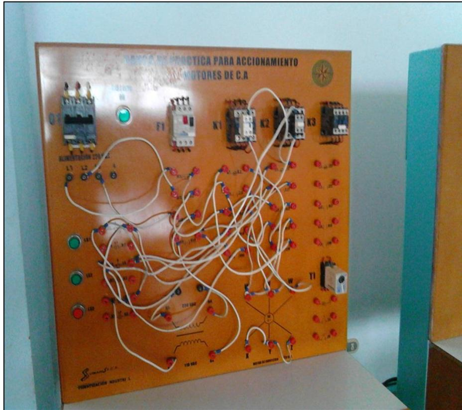
Figura B.11 Banco de práctica para el accionamiento de Motores C.A.
