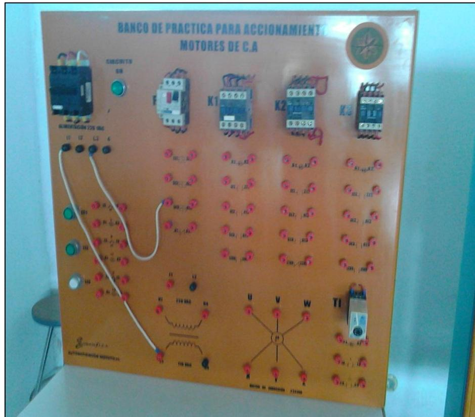
Figura B.10 Banco de práctica de accionamiento Motores C.A.
