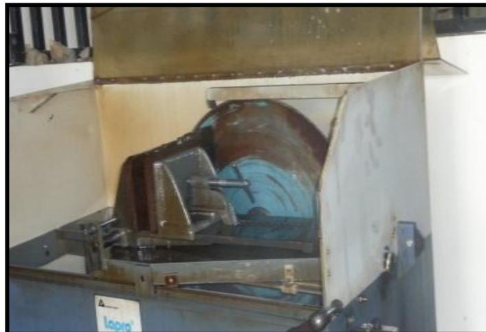
Figura 4.4 Cortadora de disco diamantado.
