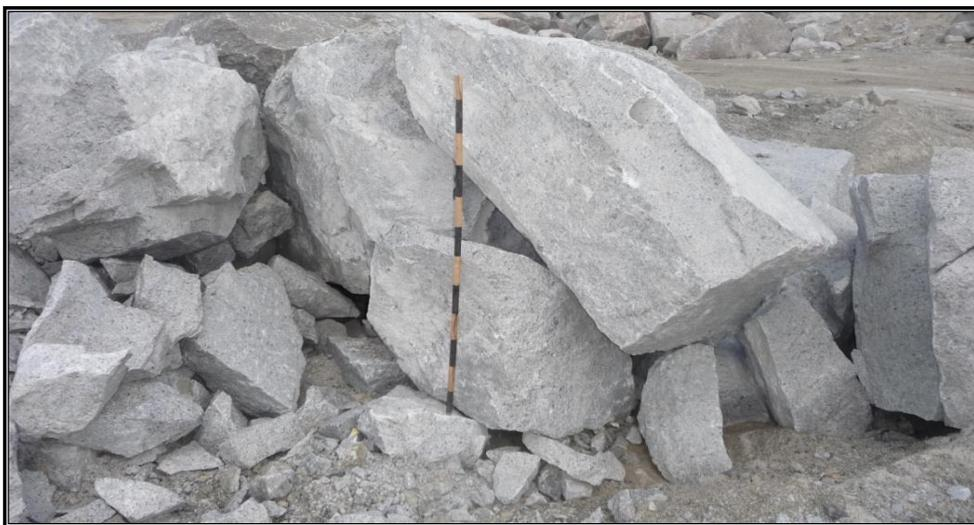
Figura 5.5 Rocas fragmentadas por voladura en el frente “D” (Escala=120 cm)
