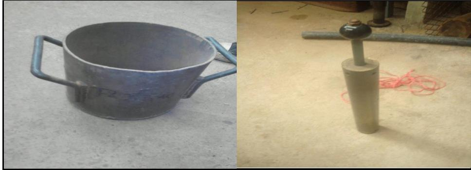
Figura 4.14 Algunos instrumentos necesarios para el ensayo de compactación.
