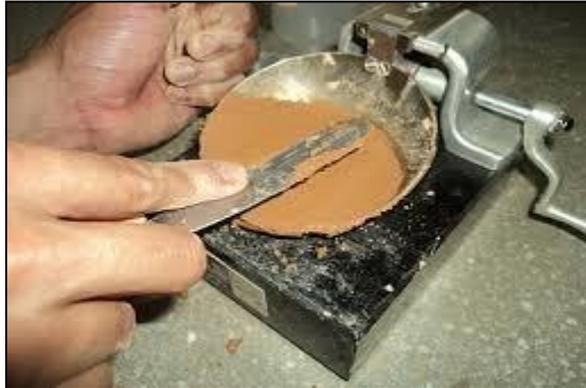
Figura 4.8 Colocado y enrasado de la muestra
