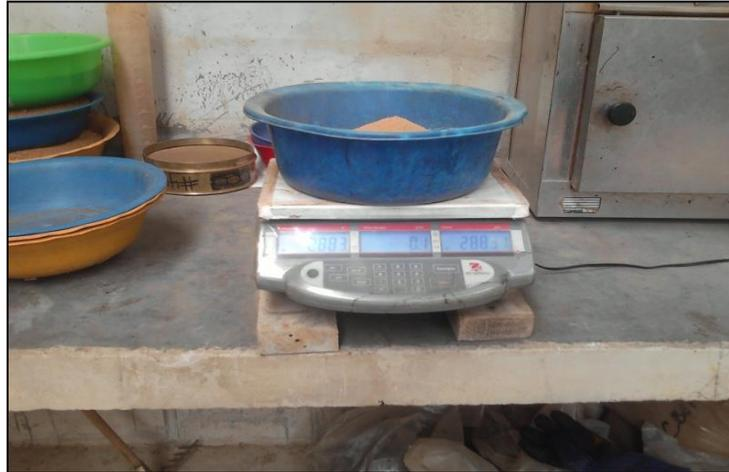
Figura 4.16 Pesando la muestra de suelo.
