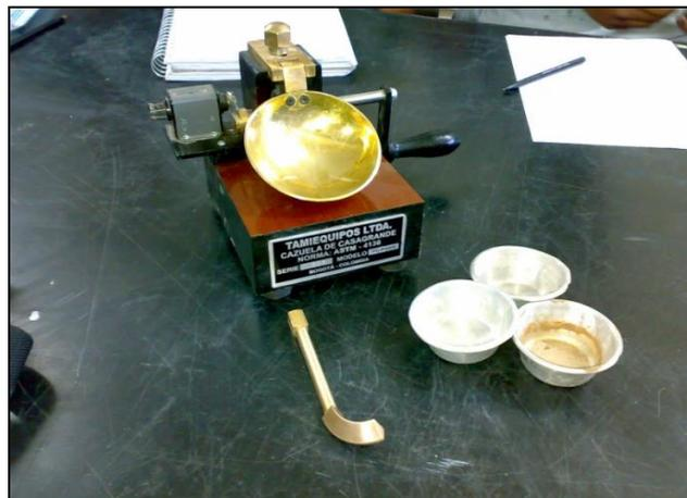
Figura 4.5 Cascador de Casagrande y Morteros
