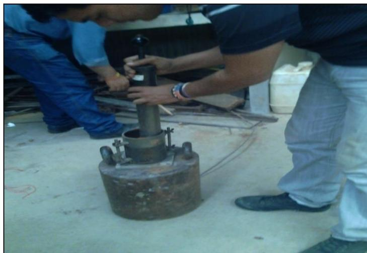
Figura 4.17 Compactando la muestra con 25 golpes.
