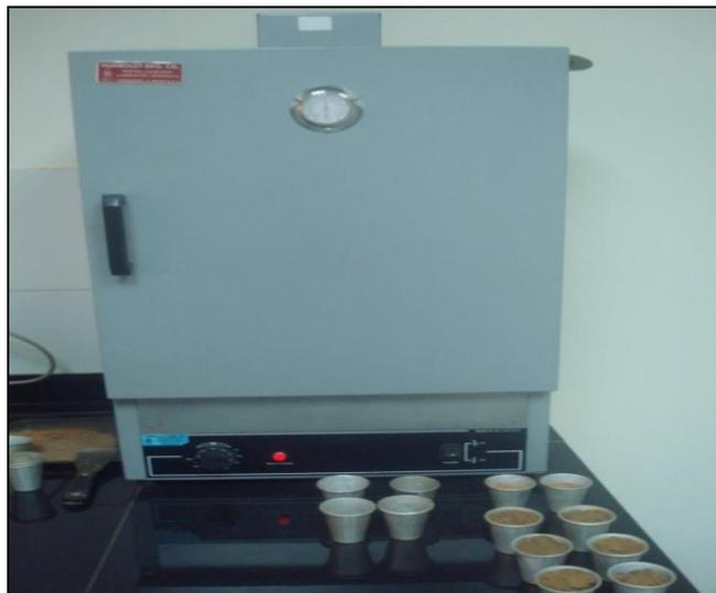
Figura 4.11 Horno y secado de muestras
