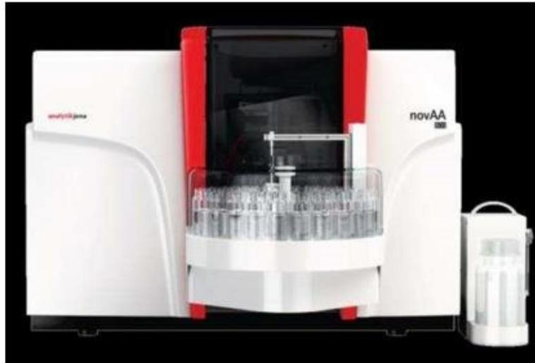
**Figura 4.** Equipo de Espectrometría de Absorción de Llama (ASS) novAA-800.
