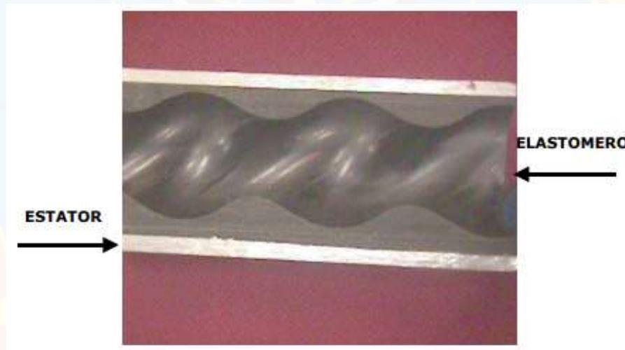
**Figura 2.8 Corte longitudinal de un estator**
