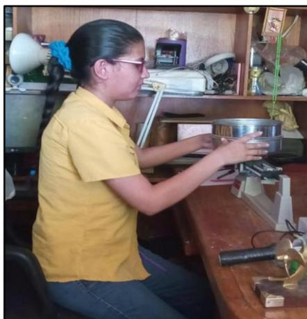
Figura 5.6 Pesaje de tamices durante el análisis granulométrico.
