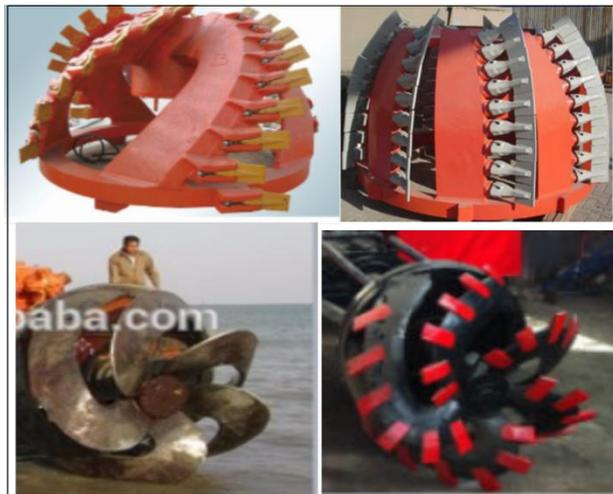
E.8 Tipos de cabezales referenciales que puede utilizar una draga de cortador.
