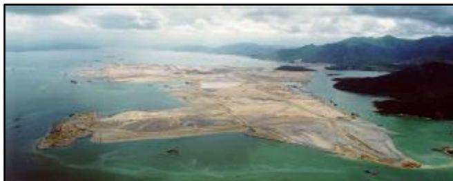
Figura 3.3 Isla artificial Chek Lap Kok en Hong-Kong construida por relleno hidráulico. ([www.bnd.nl](http://www.bnd.nl))
