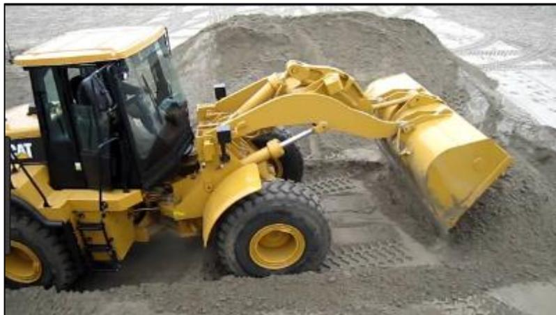
E.3 Ejemplo de un cargador frontal tipo CAT 950
