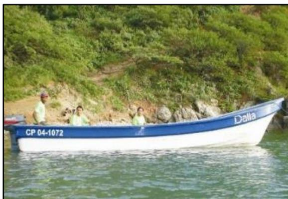
E.6 Ejemplo típico de un bote con motor fuera de borda.
