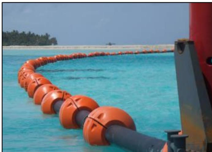
E.10 Imagen referencial de una tubería de descarga autoflotante.
