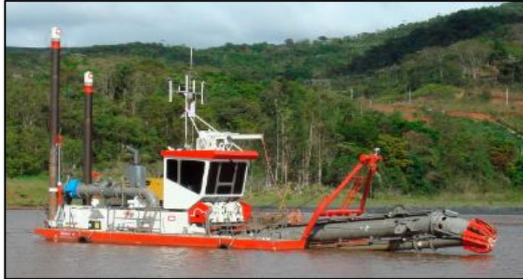
Figura 5.14 Dragadora de cortador-succión tipo IHC Beaver 1500 sin los mástiles de izado de anclas desplegados (IHC-TID, 1992).
