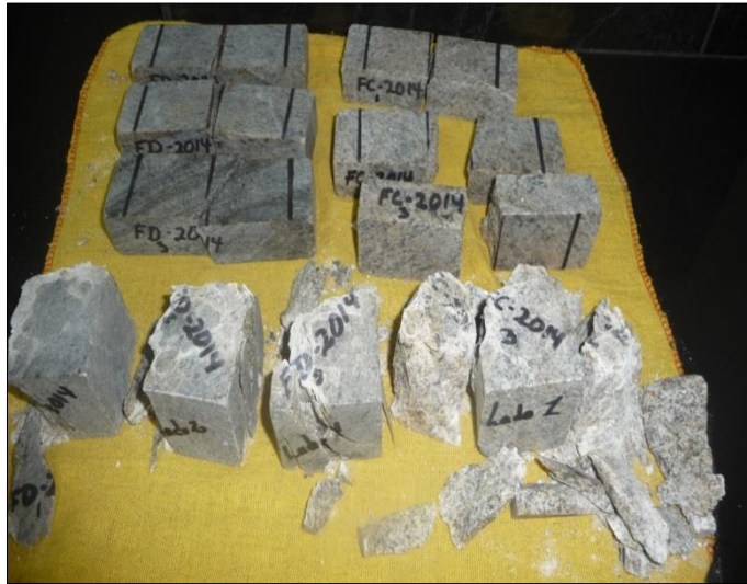
A.3. Estado final de las muestras en los ensayos de compresión y flexión simple
