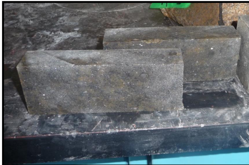
Figura 4.6 Muestras de roca preparadas en forma de regletas
