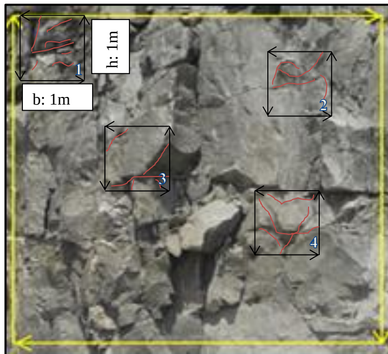
Figura 5.6 Conteo de diaclasas en una sección del Frente “C”
