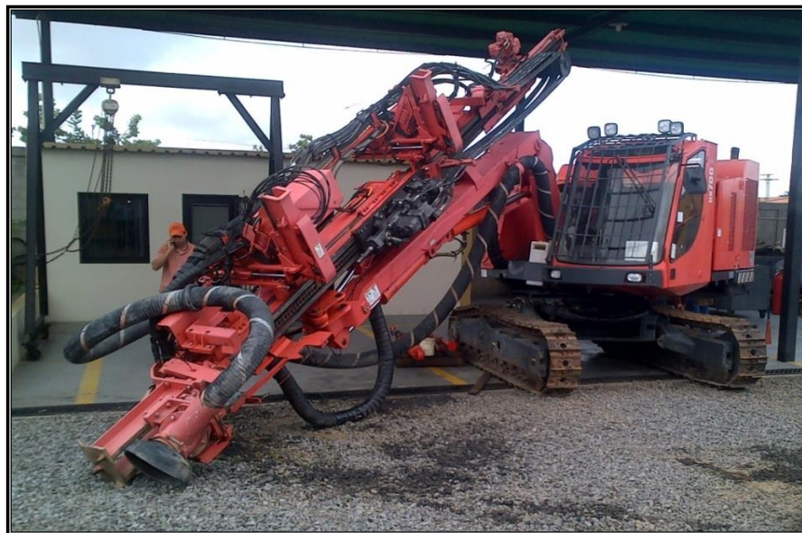
Figura 3.2 Perforadora SANDVIK DX 700 Hidráulica.
