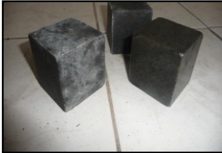
Figura 4.5 Muestras de roca preparadas en forma de cubo
