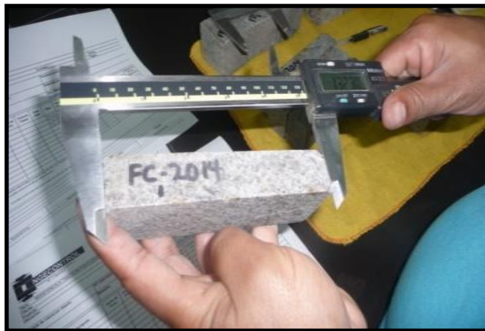
Figura 4.11 Determinación de la longitud de una de las regletas ensayadas
