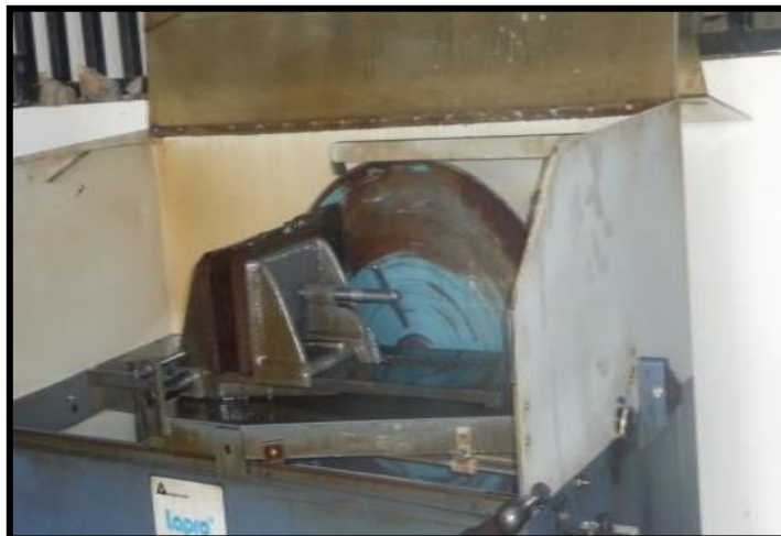
Figura 4.4 Cortadora de disco diamantado.
