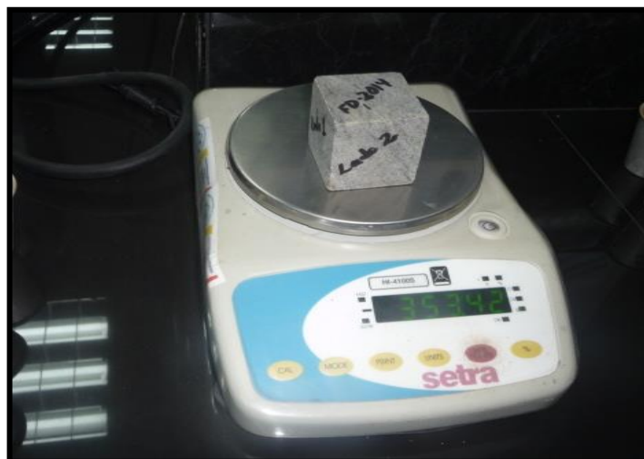
Figura 4.8 Balanza digital SETRA, modelo HI-4100S
