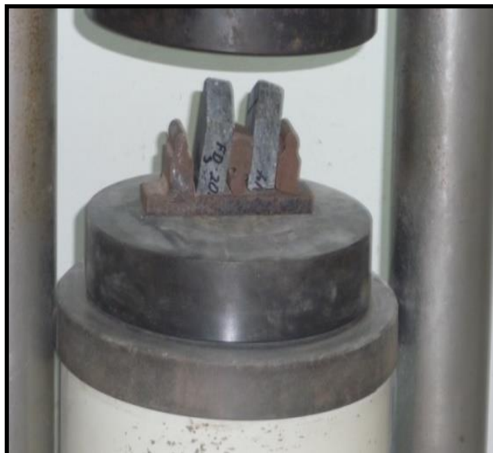
Figura 4.14 Regleta fracturada, estado final del ensayo de flexión simple.
