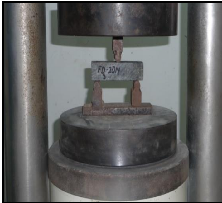
Figura 4.13 Puntos de apoyo para producir la flexión de la regleta.
