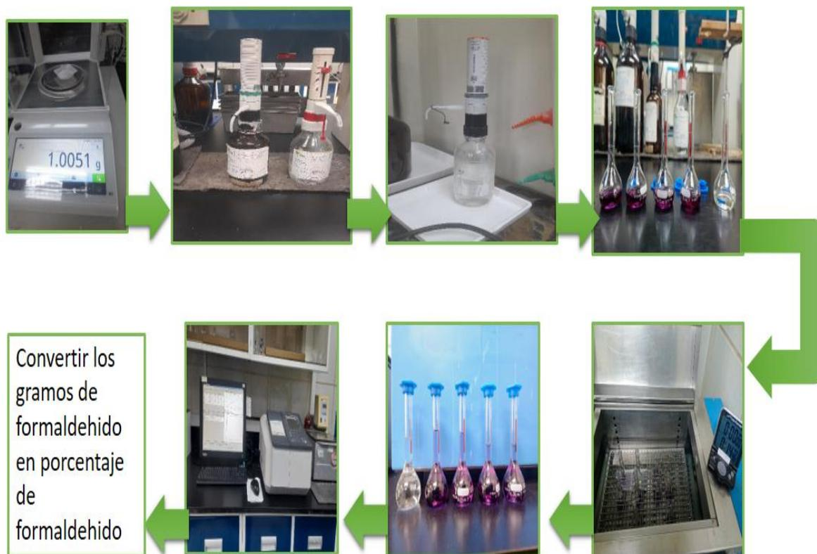
Figura C.4 Esquema del procedimiento del método para determinar formaldehido
