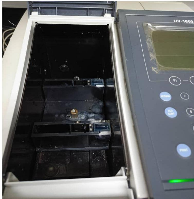
**Figura C.6: Celda de 20 mm dentro del espectrofotómetro insertadas para la lectura de biureto.**
