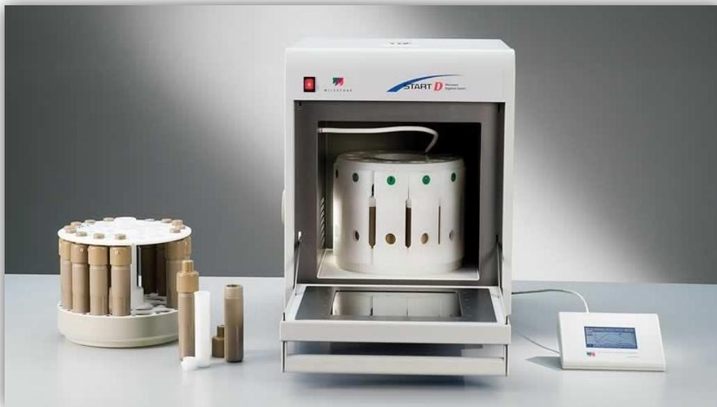
Figura 3. Digestor de microondas, modelo Stard D.
