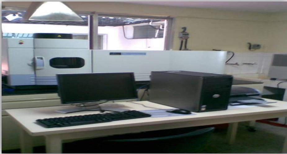
Figura 4. Espectrómetro de Emisión Óptica con Plasma Inductivamente Acoplado (ICP-OES) Optima 5300 DV.
