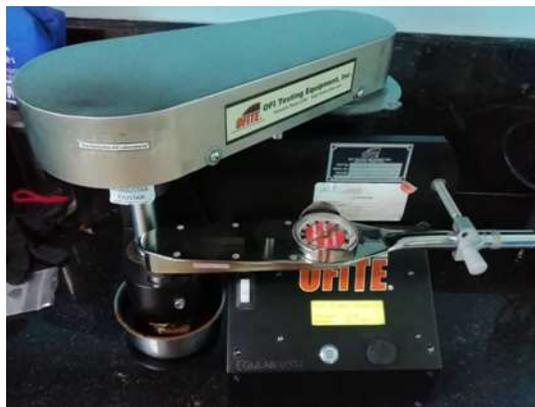
**Figura B.10 Medidor de lubricidad ofite**
