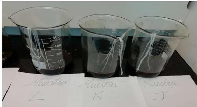
**Figura C.8 Revoques sometidos a la píldora liberadora de tubería 100% PEG-
