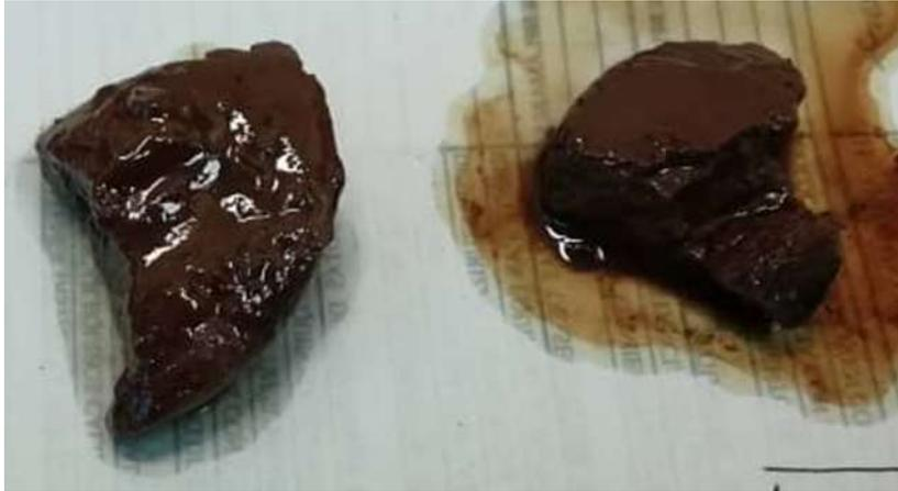
**Figura C.5 Revoques luego de someterlos a la píldora liberadora de tubería
