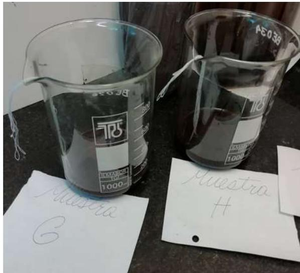
**Figura C.6 Revoques sumergidos en la píldora liberadora de tubería 50%PEG-
