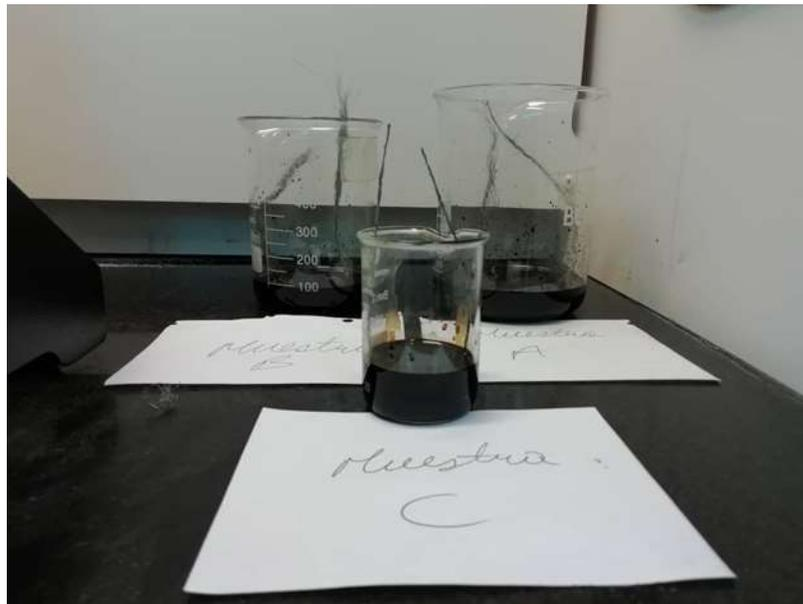
**Figura C.2 Revoques sometidos a la pílora 100% aceite de coque de petróleo**
