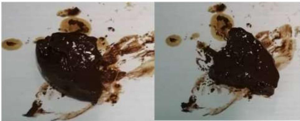
**Figura C.9 Revoques luego de someterlos a la píldora liberadora de tubería
