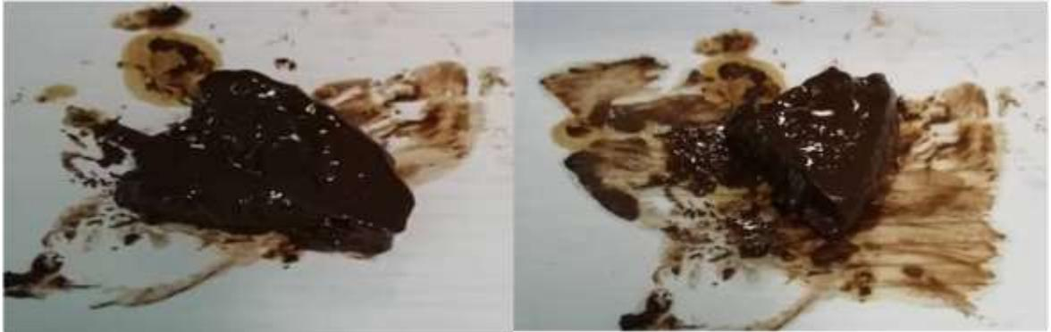
**Figura C.7 Revoques luego de someterlos a la píldora liberadora de tubería
