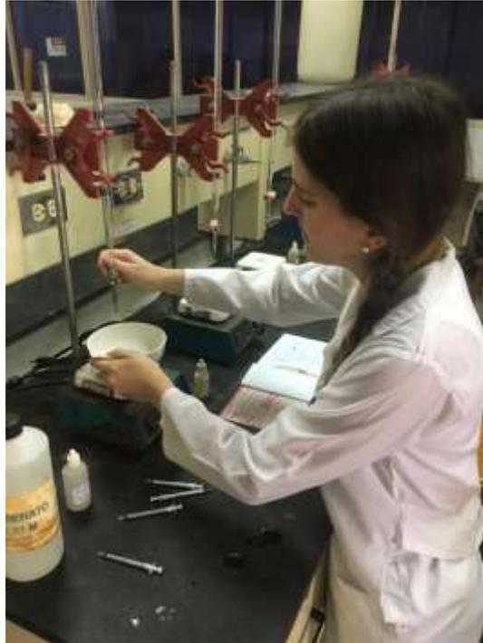
**Figura C.7. Ensayo de titulación, cálculo de la dureza del agua contenida en los diferentes acuarios**
