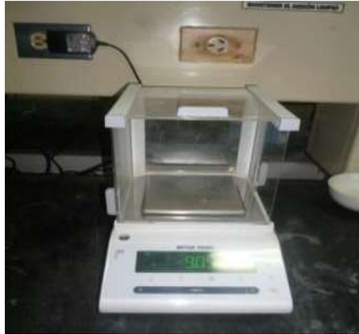
**Figura A.5 balanza analítica**
