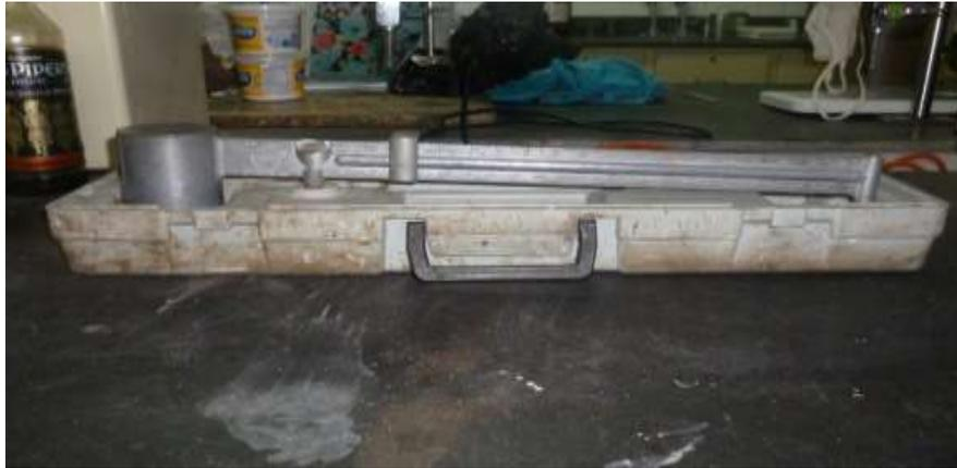
**Figura A.1 Balanza de lodo**
