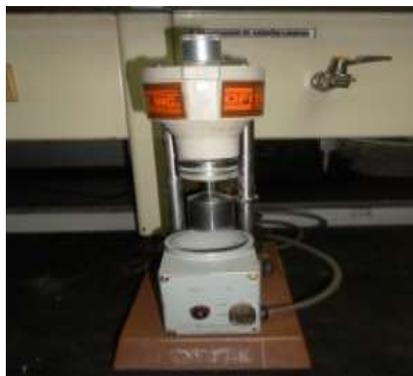
**Figura A.2 Viscosímetro rotacional FANN**
