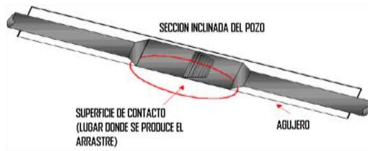
**Figura 4.24 Tool Joint en contacto con una de las paredes del agujero en una sección inclinada**
