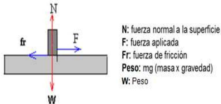
**Figura 2.1 Fricción entre un cuerpo y la superficie**
