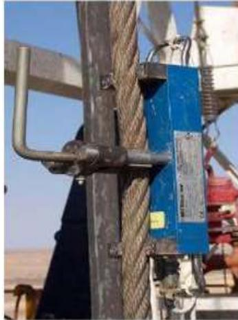
**Figura 4.9 Sensor de carga**
