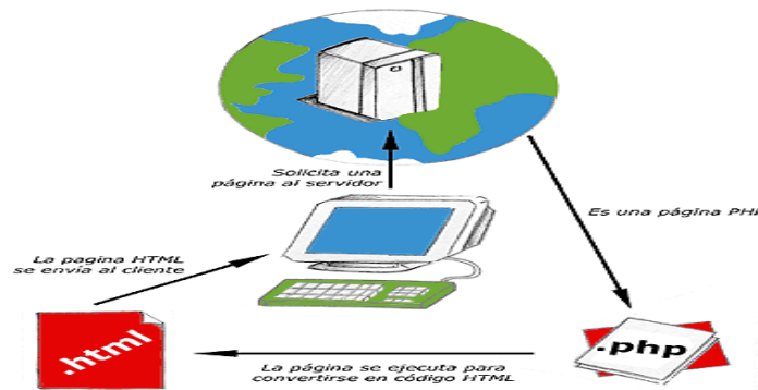
Figura 15 Funcionamiento de página PHP en un servidor
