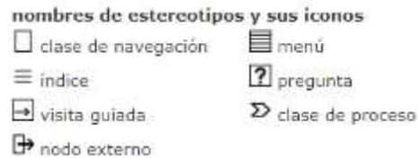
**Figura 7. Estereotipos para diagramas de navegación**
