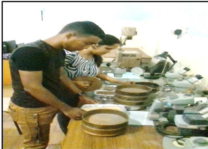
Figura 4.8 Preparación de la muestra y los tamices para el análisis granulométrico.
