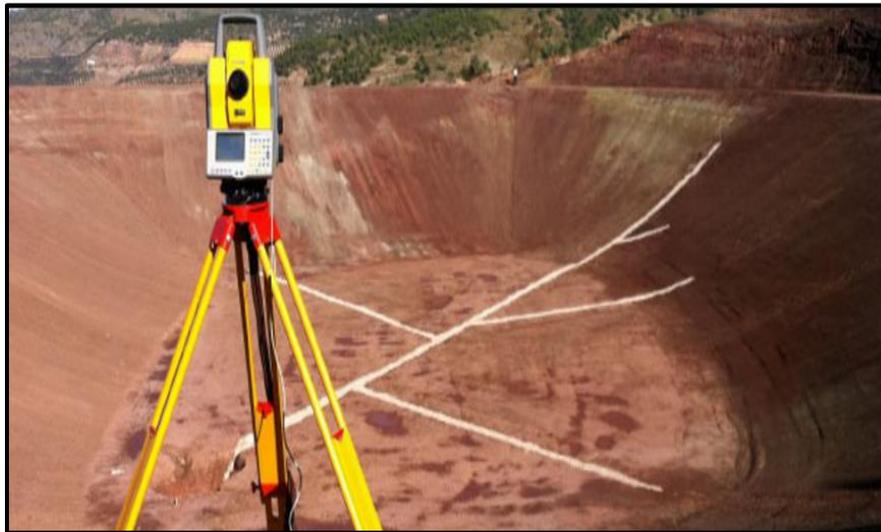
Figura 3.9 Levantamiento topográfico con estación total (Davis, R 2017).
