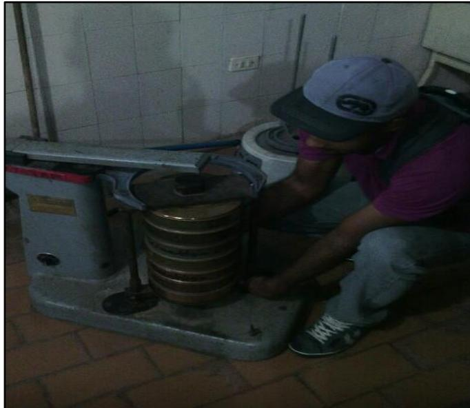
Figura 4.4 Juego de tamices y agitadora empleada para los análisis granulométricos.
