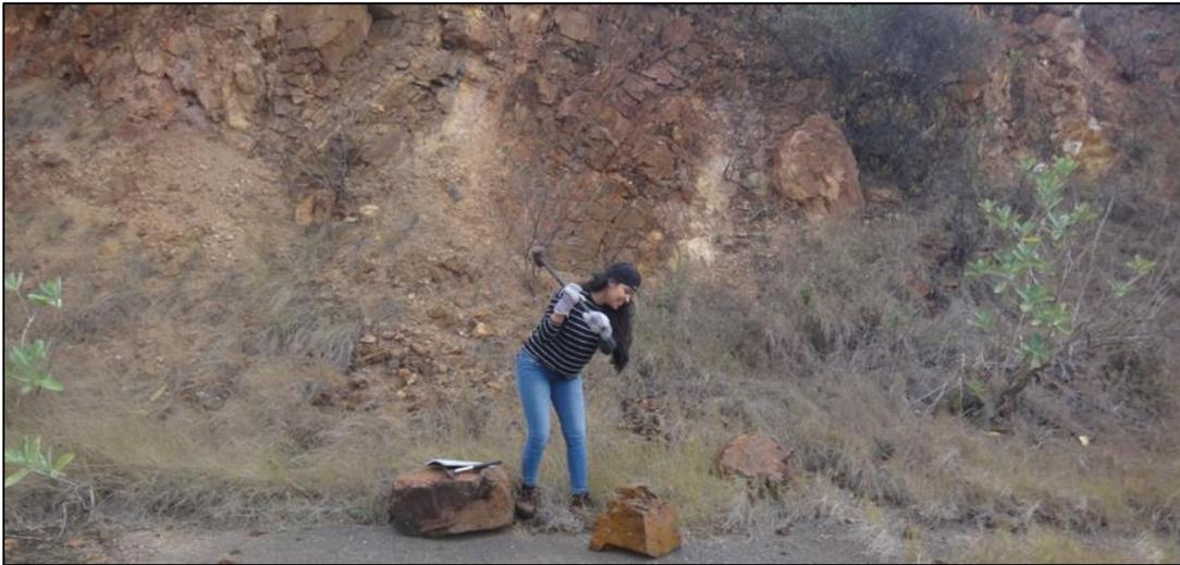
Figura 4.4 Obtención de las muestras de rocas mediante percusión.
