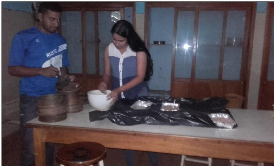
Figura 4.6 Preparación de las muestras para el tamizado mecánico.
