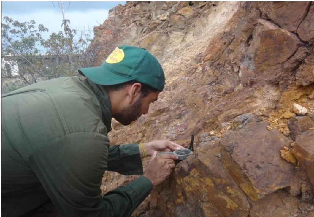
Figura 4.3 Medición de un plano de fractura, en un corte de carretera, cercano al estribo norte del puente.
