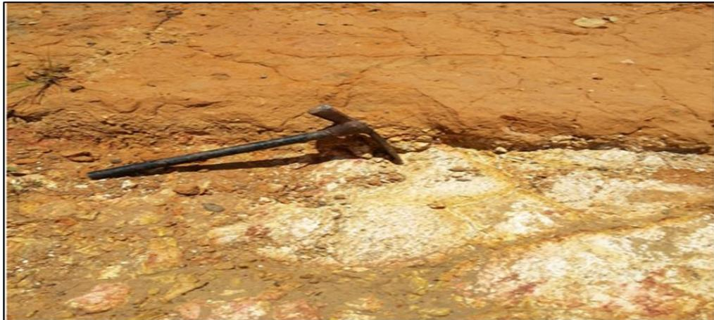
Figura 5.8 Contacto geológico de la Formación Mesa (capas suprayacente de color mostaza) y el Complejo Imataca (infrayacente de color rosado pálido).
