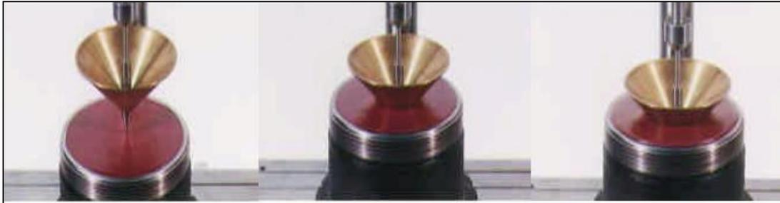
Figura 5.11 Ensayo de penetración. (Vidal N, 2020).
