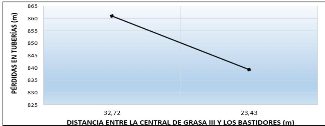
Figura 5.9 Pérdidas de energía tubería del tren terminador II. (Vidal N, 2020).
