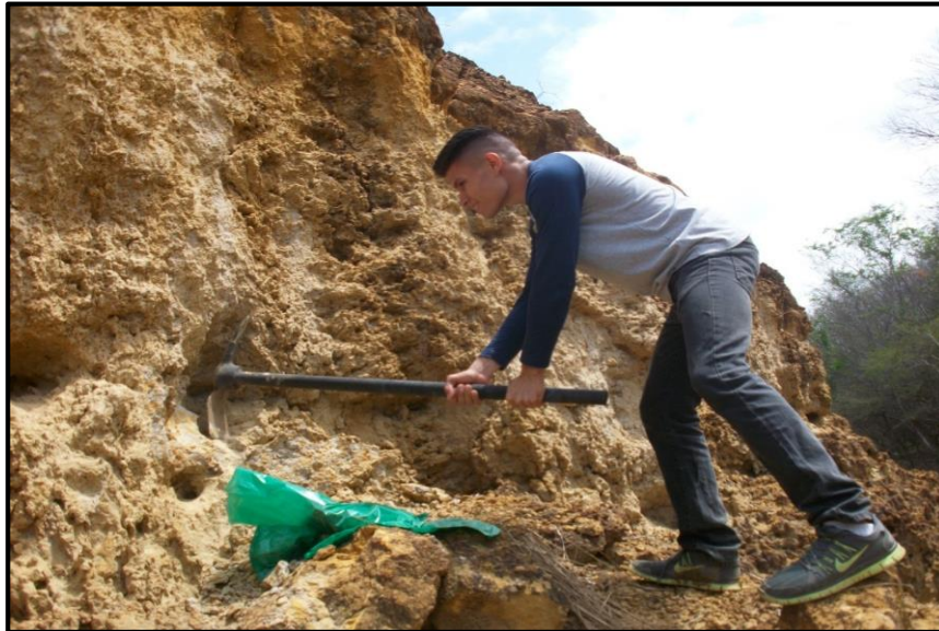
Figura 5.6 Elaboración de calicatas en campo
