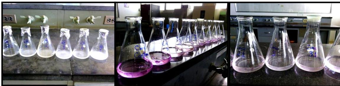
Figura 4. Titulación realizada para la determinación de la biomasa microbiana por respiración inducida por sustrato (RIS).
