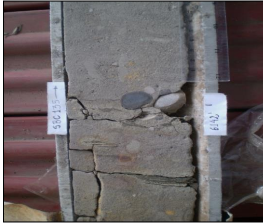
Figura 5.6 Arenisca sin estructura interna sobre conglomerados de caliza (OMNI Laboratories, Inc., 2005).
