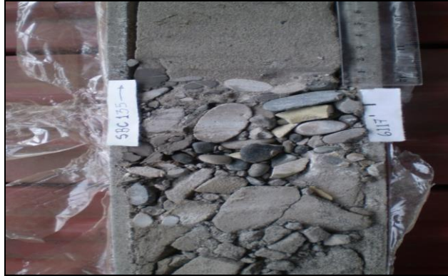
Figura 5.4 Conglomerados confinados entre areniscas de grano medio a fino (OMNI Laboratories, Inc., 2005).
