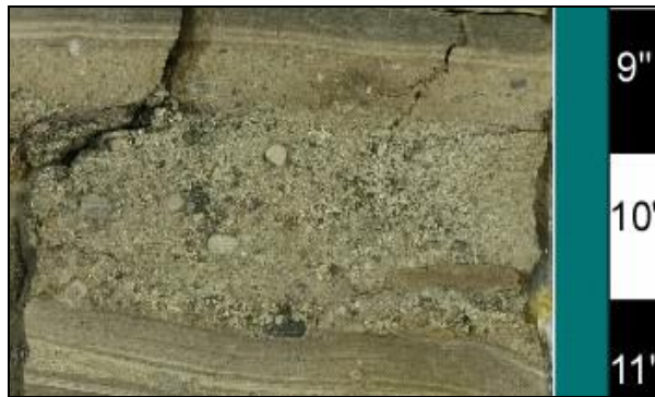
Figura 5.5 Arenisca de granos gruesos, mal escogida y sin laminación. (OMNI Laboratories, Inc., 2005).
