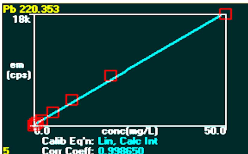
Figura 11. Curva de calibración de Pb por ICP-OES
