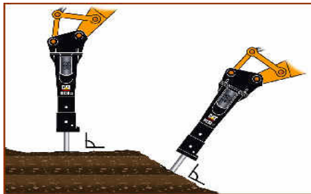
Figura 27. Manera correcta al colocar un martillo hidráulico.
