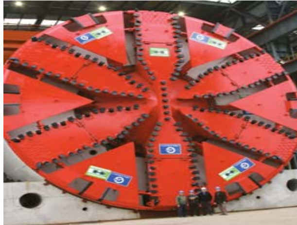
Figura 16. Maquina TBM Bouygues Modelo STEC Diámetro 15.43m.
