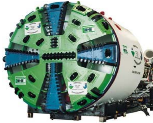
Figura 9. Escudos de balance de presión de tierras o EPB.
