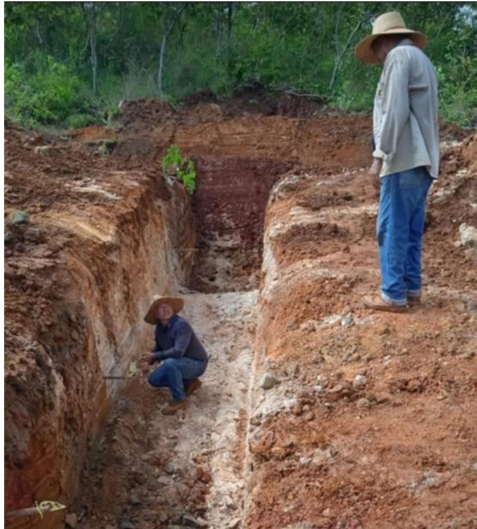
Figura 5.8 Revisión de la Trinchera C1, una vez excavada. La parte en blanco corresponde a las Casiterita descompuesta.
