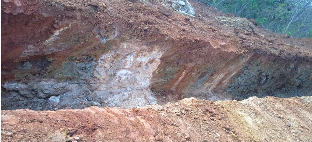
Figura 5.9 Pared de la Trinchera C2, donde se observa el muestreo sistemático de la zona de interés (Casiterita en color blanco y zona de alteración).
