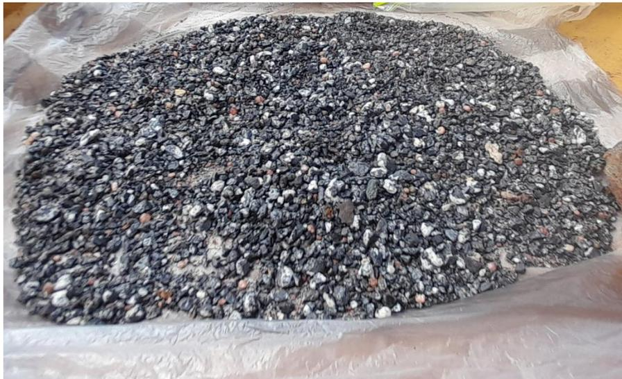
Figura 5.11 Muestra seleccionada para determinar un mineral de color rojo, los otros minerales son Cuarzo, mica Muscovita, Casiterita, mica Biotita, arenas y fragmentos de rocas. El mineral se identificó como Granate Almandino.
