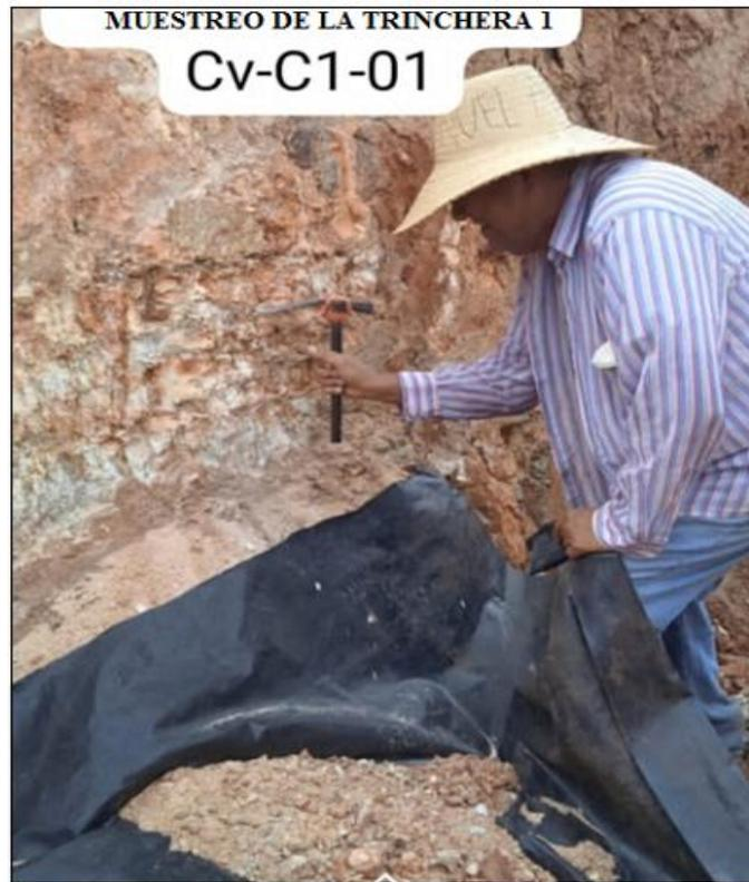
Figura 4.5 Muestreo de la Trinchera C1. La zona Pegmatítica es muestreada sobre un plástico y de una vez cuarteada y recolectada la muestra.
