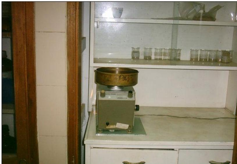
Figura 4.9 Pesado de los tamices para iniciar los ensayos granulométricos.
