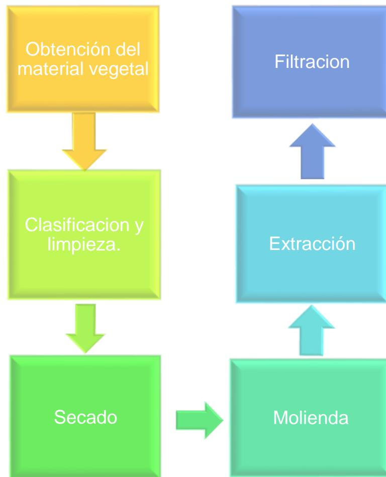
**Figura 1. Diagrama de flujo del proceso de producción y obtención de colorantes.**
