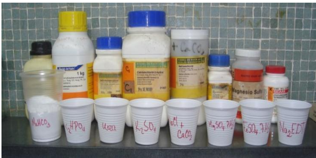
Figura 3. Sales y componentes utilizados en el medio nutritivo Zarrouk (1966) con modificaciones propias en sus cantidades respectivas. Se muestran las sales: agente quelante ( \text{Na}_2\text{EDTA} \cdot 2\text{H}_2\text{O} 0,11 g/l), bicarbonato de sodio ( \text{NaHCO}_3 17 g/l), fosfato de potasio ( \text{K}_2\text{HPO}_4 , 0,5 g/l), Urea (0,9 g/l), sulfato de potasio ( \text{K}_2\text{SO}_4 , 1 g/l), cloruro de sodio ( \text{NaCl} , 1 g/l), sulfato de magnesio ( \text{MgSO}_4 \cdot 7\text{H}_2\text{O} , 0,2 g/l), cloruro de calcio ( \text{CaCl}_2 \cdot 2\text{H}_2\text{O} , 0,04 g/l).
