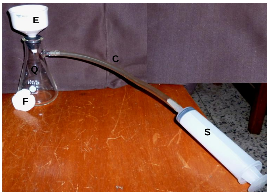
Figura 6. Sistema de filtración al vacío para la separación de la biomasa de Arthrospira maxima desarrollado en el laboratorio. E: embudo de porcelana; Q: matraz kitasato; F: filtro malla doble de nilón; C: conector de plástico; S: poder de succión (jeringa de 60 ml). Todos los materiales con “grado alimenticio”.
