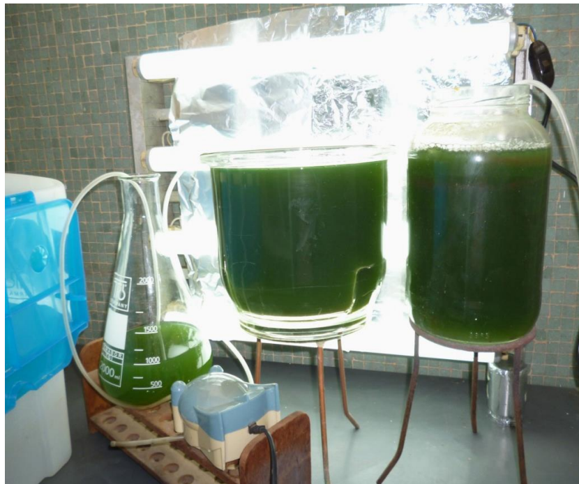
Figura 12. Cultivo experimental de Arthospira maxima . Se observa coloración verde-azulada y agregados de espirulina en constante agitación.
