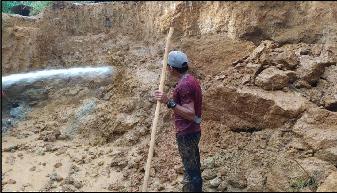
Figura 5.12 Corte minero con motores hidráulico para estimación de recurso de diamante
